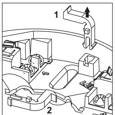
La base è dotata di apposito dispositivo di blocco per prevenire la rimozione del sensore non autorizzata
